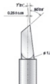
**Zec-U1715:** Lame de découpe adaptée à l'utilisation de matériaux épais du type Masque de Sablage et , Flock.
